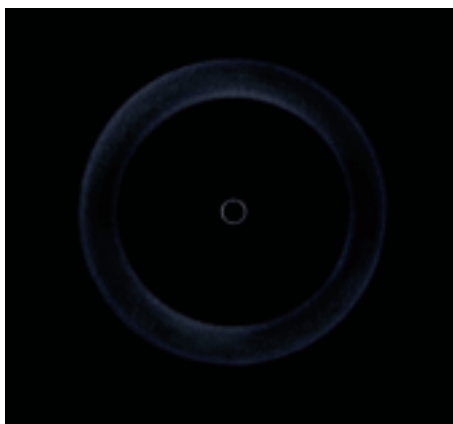
一般ポリカーボネートシート 耐擦傷性テスト(500g×100回)
